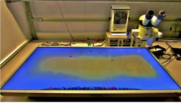
**Recht häufiger Fehler bei großflächigen Displays im Dauerbetrieb, auf Bahnhöfen, Flughäfen etc., die technisch nicht dafür ausgelegt sind. Thermische Degradation von optischen Materialien und Komponenten.**
