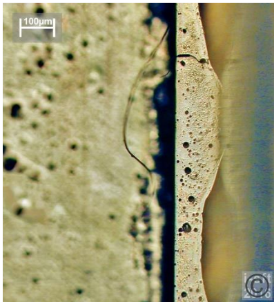
Senkrechte Laminat-Kante: links ist der Blick durch den gebondeten optical stack mit sichtbar gemachtem Flüssigkleber und rechts sieht man überschüssigen Kleber, der entlang der Laminatkante abgezogen wurde.
