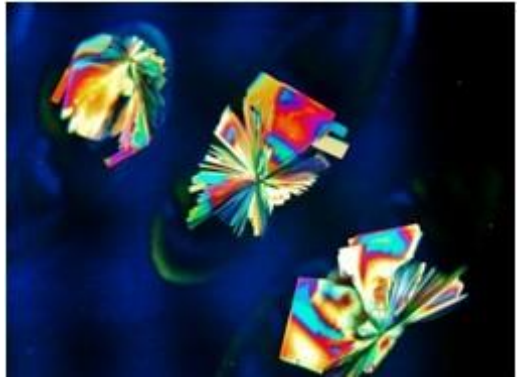
Ghost Pixel – störende Artefakte durch chemische Reaktionen im Display – durch eingedrungene Feuchtigkeit.
