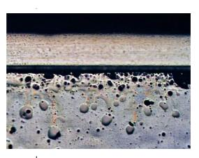
Analyse eines Optical Bonds mit flüssigem Kleber (OCR): Die untere Bildhälfte zeigt die Bond-Fläche mit vielen Blasen und Teilablösungen. Beides steigert sich zur Gerätekante (schwarzer Streifen in der Bildmitte). In Fehlfarbendarstellung lässt sich sogar die verbleibende Restklebekraft ablesen und die Diffusionskanäle von der Kante nach innen erkennen.
